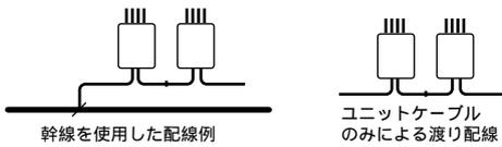
伝送ラインの最遠端にターミネータAT4を接続してください。各伝送クロックに共通です。伝送ラインが分岐する場合は、AnyWire DBテクニカルマニュアルをご覧ください。
