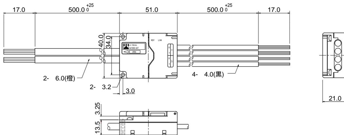
DINレールアダプタ (ADP-19) によるDINレール搭載寸法
