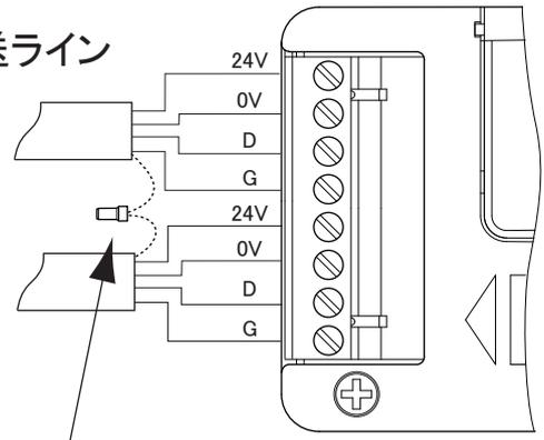
シールドケーブルの場合は外部で中継処理を行い1点アースにしてください。
