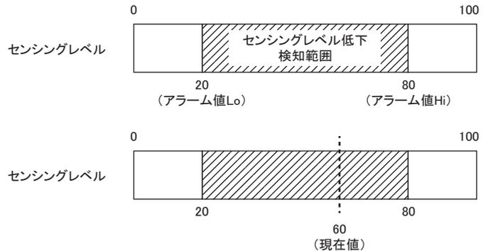
この状態が5000ms(機器パラメータ5: 50 × 100ms)以上継続すると、センシングレベル低下として検知し、本体ALMランプで知らせるとともに、アラーム情報をマスタ側のステータス詳細エリア\*に上げます。
