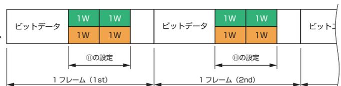
▶ 1 フレームに割り当てるワードデータ点数を小さくすると全ワードデータの更新に必要なサイクル回数は増えますが 1 フレーム長を短くする事ができます。(ビットデータ更新時間へ与える影響を小さくできます)
