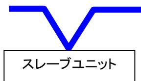
実際の配線では、次図のように片側からの通信ケーブルと、もう一方側の伝送ケーブル、それぞれの信号線を合わせて、スレーブユニットに接続します。
