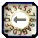
AFSR01 前面の MODE スイッチを設定することにより、Bit-Bus および Word-Bus の伝送点数を設定します。
