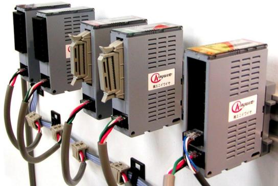
コンパクトターミナルへの接続は LP コネクタ(組み立て式コネクタ)と EP コネクタ(「e-CON」コネクタ)又は 20 ピン MIL コネクタによって接続されます。
