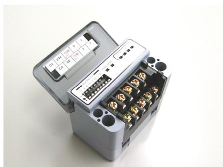
スレーブユニットの取り付けは 35mm 幅 DIN レール取り付け、またはビス取り付けが可能です。
