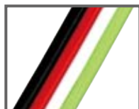
4 芯フラットケーブル AWG18 (0.75sq) x 4 芯 (左から G:D:OV:24V)
