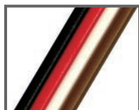
4芯フラットケーブル AWG16 (1.25sq) x 4芯 (左から G:D:0V:24V)
