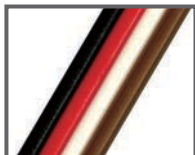
4芯フラットケーブル AWG16 (1.25sq) x 4 芯 (左から G:D:OV:24V)
