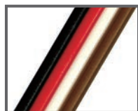
4芯フラットケーブル AWG16 (1.25sq) x 4芯 (左から G:D:0V:24V)
