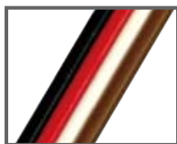
4 芯フラットケーブル AWG16 (1.25sq) x 4 芯 (左から G:D:O:V:24V)
