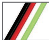
4芯フラットケーブル AWG18 (0.75sq) x 4芯 (左から G:D:O:V:24V)
