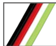
4 芯フラットケーブル AWG18 (0.75sq) x 4 芯 (左から G:D:0V:24V)
