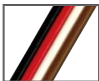
4 芯フラットケーブル AWG16 (1.25sq) ×4 芯 (左から DN:DP:OV:24V)
