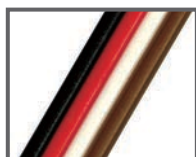
4芯フラットケーブル AWG16 (1.25sq) x4芯 (左から DN:DP:0V:24V)
