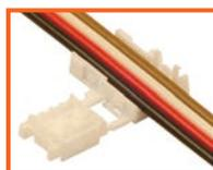
専用フラットケーブルと LP コネクタ (リンクコネクタ) の組み合わせで使用の際は、写真の様にコネクタカバーの蝶番側(1番)に黒い電線 (DNライン) が来るように結線してください。
