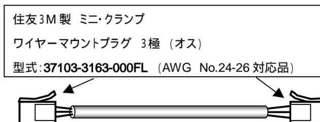
上図は住友3M製プラグを使用した例です。タイコエレクトロニクスアンプ製 RITS コネクタプラグも同規格品になります。いずれかで製作します。それぞれ適合電線により型式が変わります。
