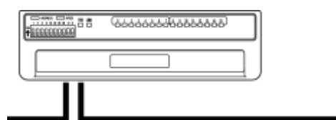
実際の配線では、図のように片側からの伝送ケーブルと、もう一方側の伝送ケーブル、それぞれの信号線を合わせて、スレーブユニットに接続します。
