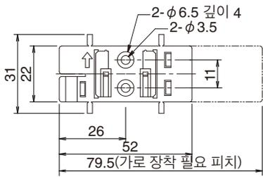
● DIN 레일 어댑터는 직접 장착할 수 있습니다. DIN 레일 어댑터를 이용하여 모듈을 직접 장착하는 경우, 어댑터의 간격을 15mm 이상 두고 장착하십시오. 모듈을 장착하기 위해서 필요합니다.
