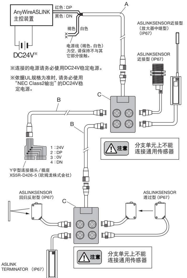
※连接的电源请务必使用DC24V稳定电源。
