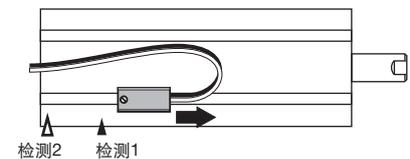
⑦ 将ASLINKSENSOR固定在橙色LED亮灯位置(检测1、2)的中间。
