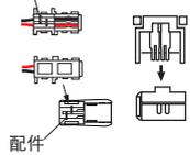
将本体金属配件插入盖子孔后,用专用工具压接。
