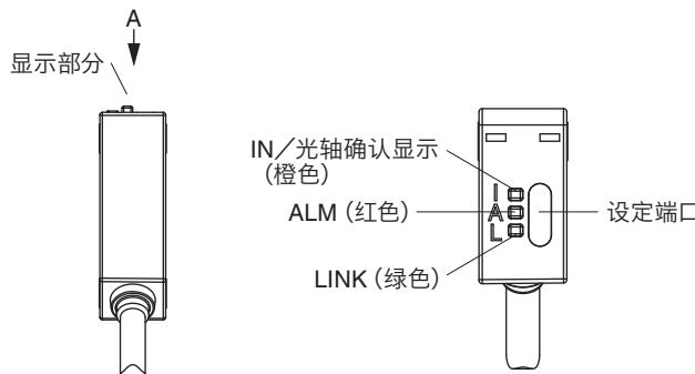
※投光侧没有IN/光轴确认显示。
