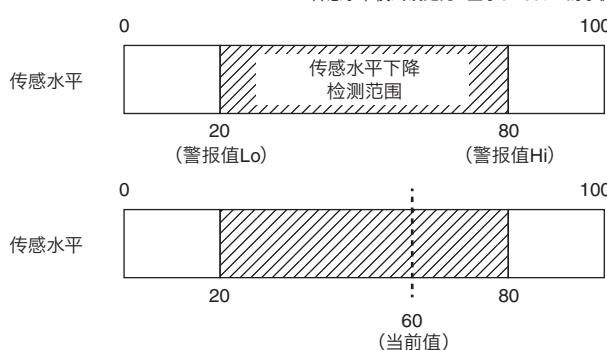
如果该状态持续了5000ms (机器参数5: 50x100ms) 以上, 则检测为传感水平下降, 并且以本体ALM指示灯通知, 同时将警报信息上传到主模块侧的状态详细区<sup>※1</sup>。
