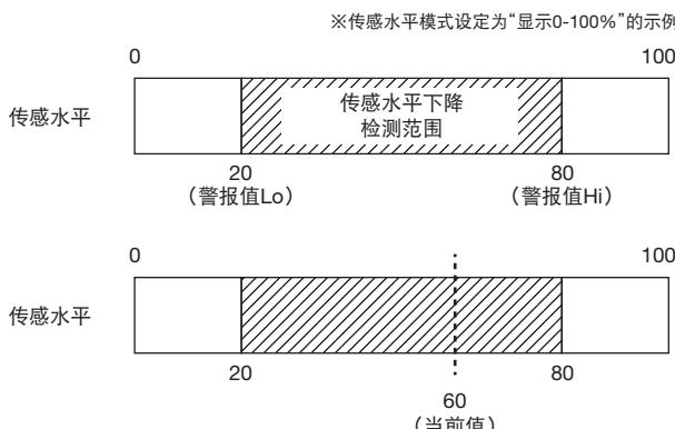
如果该状态持续了5000ms(机器参数5: 50×100ms)以上，则检测为传感水平下降，并且以本体ALM指示灯通知，同时将警报信息上传到主控装置侧的状态详细区※1。
