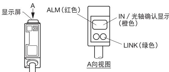
※投光侧没有IN / 光轴确认显示。
