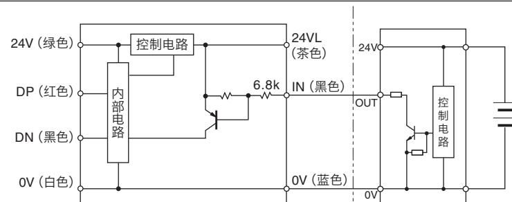
4线式(绝缘) ASLINKER (AnyWire系列电源)
