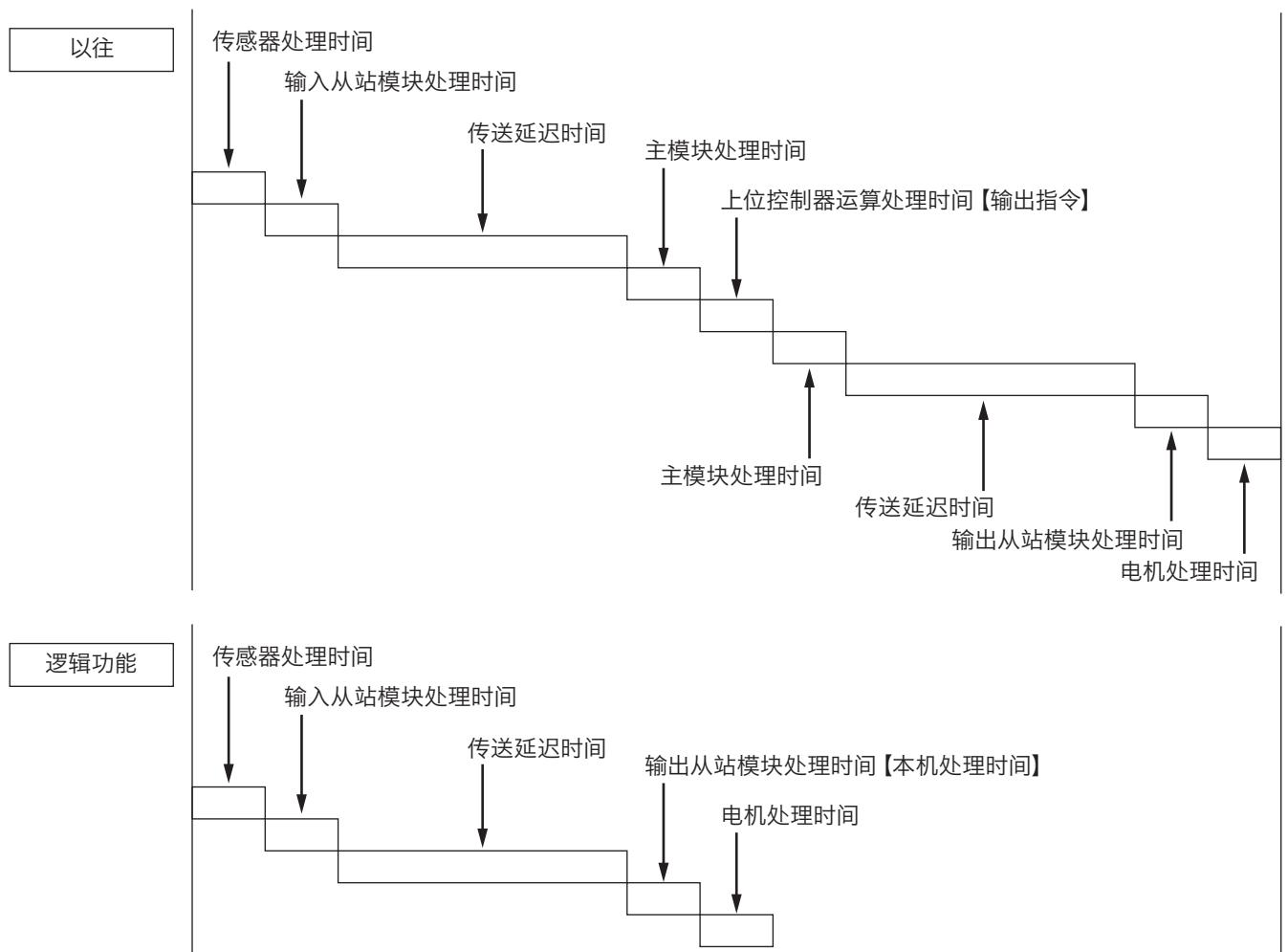
无上位程序, 参照传感器的ON信号, 输出到电机。
