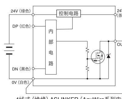
4线式(绝缘) ASLINKER (AnyWire系列电源)
