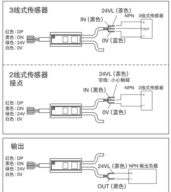
※干线侧 24V 与 I/O 侧 24VL 请不要共用。否则 I/O 短路检测功能不会正确动作。
