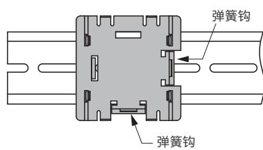
2. 先将固定钩侧挂在轨道上, 然后将弹簧钩侧朝箭头方向按入, 直到听见咔嚓音。
