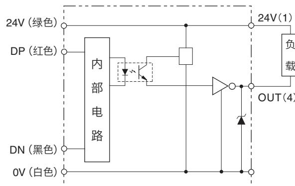
感应性负载时,请安装浪涌抑制器。
