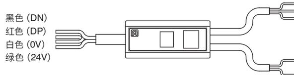
将线放入槽内, 使护罩的铰链侧为黑线 (DN), 将A折进B侧, 挂上挂钩C固定。
