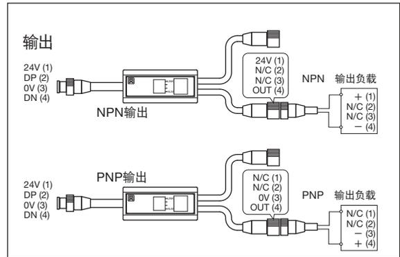
**注意** 要连接与AnyWireASLINK所使用的电源不同的电源所控制的负载（输入输出端口等）时，请务必使用4线式（绝缘）模组。否则，可能导致误动作。
