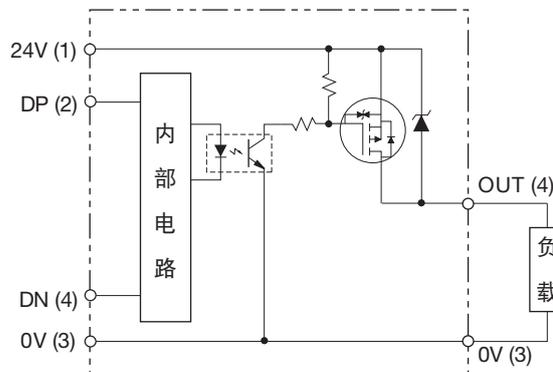
感性负载时, 请安装浪涌抑制器。
