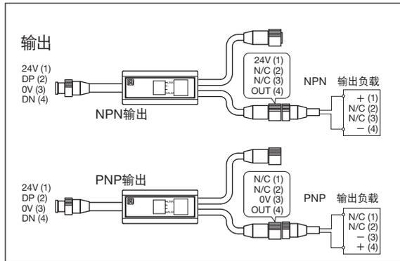
**注意** 要连接与AnyWireASLINK所使用的电源不同的电源所控制的负载（输入输出端口等）时，请务必使用4线式（绝缘）模组。否则，可能导致误动作。
