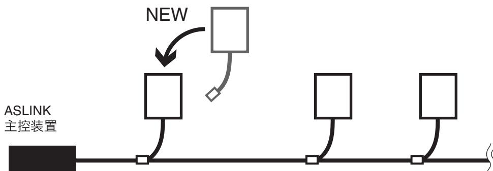
■步骤4 开启供给主控装置的DC24V电源。
