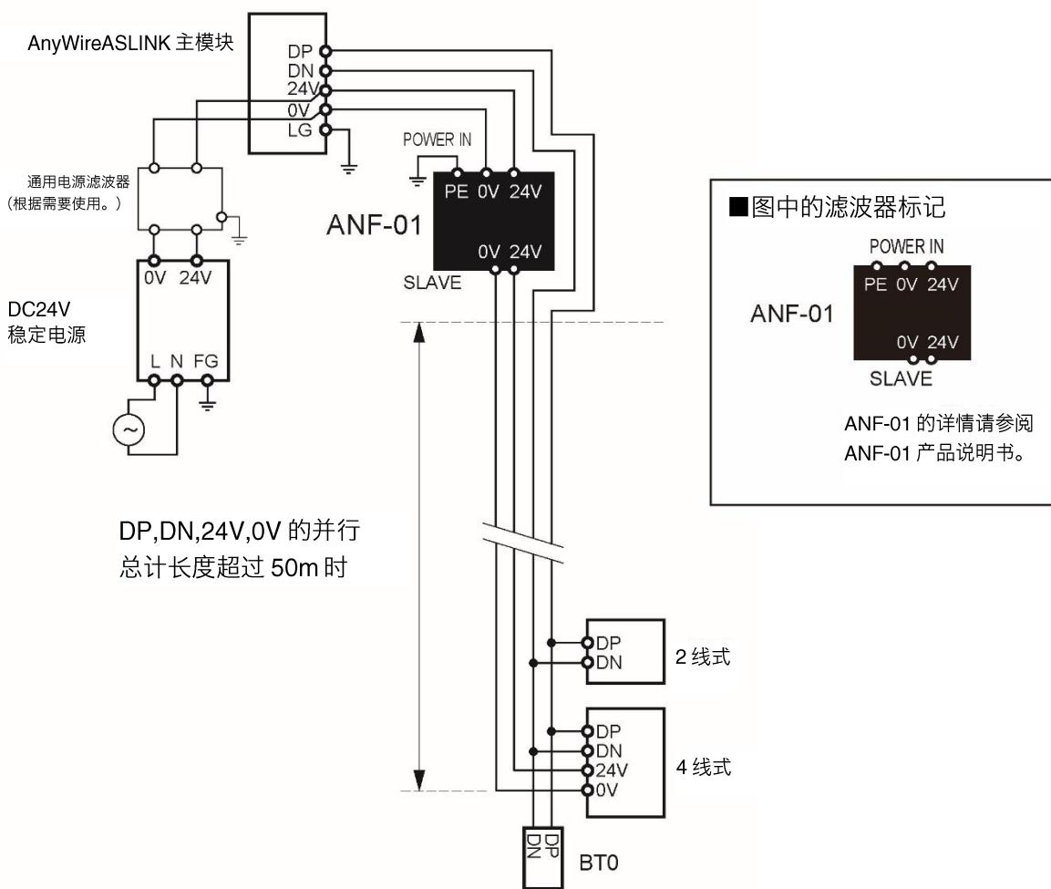
(局部供电时的 ASLINK 滤波器 (ANF-01) 连接例)
