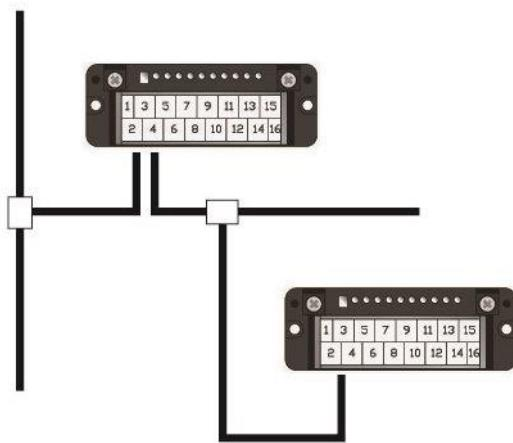
实际配线方法与T形分支方式和多点分支方式相同。
