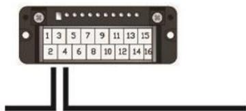
实际配线方法如下图所示、将一侧的传送电缆和另一侧的传送电缆、对合各信号线并连接在从站模块上。
