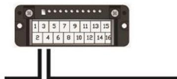
实际配线方法如上图所示，将一侧的传送电缆和另一侧的传送电缆，对合各信号线并连接在从站模块上。
