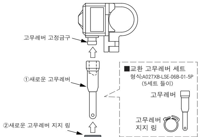
(2) 고무레버 지지 링을 정면도의 (D)위치(고무레버 끝부분)에 장착합니다. 장착은 플라이어 등으로 검은색 표시 부분을 C방향으로 밀어 스톱퍼의 걸쇠가 D와 E에 닿을 때까지 접합시켜(F 참조) 고무레버 밑부분의 외주를 헐겁게 합니다. 단단히 조인 후에는 레버를 잡아당겨 확실하게 고정되었는지 확인하십시오.
